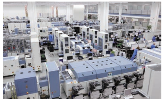
지멘스 암베르크 공장 내 모든 기계장치는 기계 이상과 불량품 생산을 감지하는 1000여 개의 센서와 스캐너가 설치돼 있다. © Siemens
