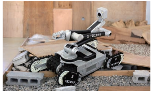
원전 사고 현장에서 방사선량을 모니터링할 목적으로 개발된 로봇 '사쿠라'. © fuRo
