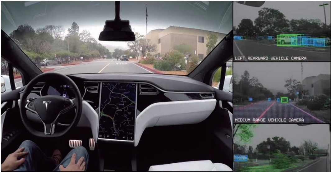
테슬라의 차량으로 자율주행을 시연하는 장면. 여러 카메라와 센서로 잡은 정보를 이용해 주변 상황을 분석해야 한다. © Tesla
