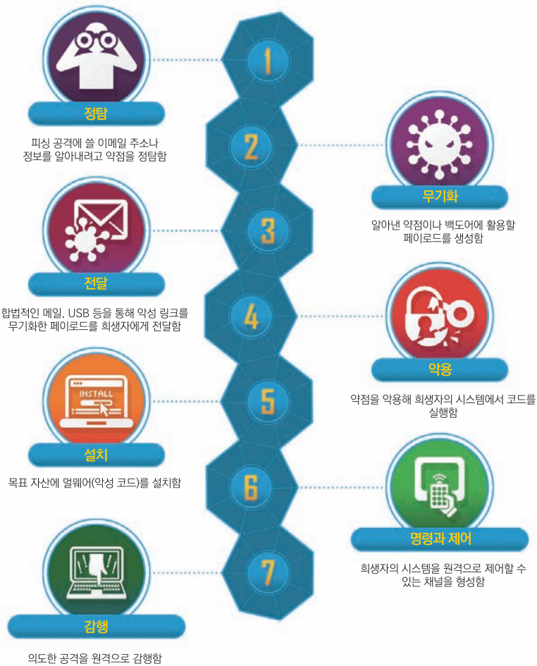
〈그림 4-17〉 사이버 킬 체인인 침입 킬 체인(intrusion kill chain)의 구성과 공격 수행 단계
