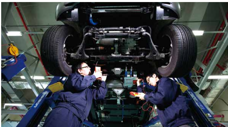
현대·기아차 연구원들이 수소연료전지차 차체를 들어올려 연료전지 스택을 장착하고 있다. 최근 국내 기술로 연료전지스택 원천기술이 개발되어 기대를 모으고 있다.
