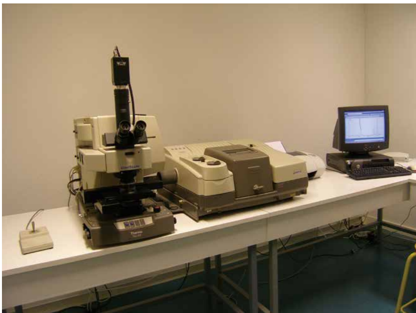
적외선 가스센서는 적외선 분광기와 동일한 원리를 이용한다. 적외선 분광기는 기체나 액체의 조성을 알아내는데 유용하다.
