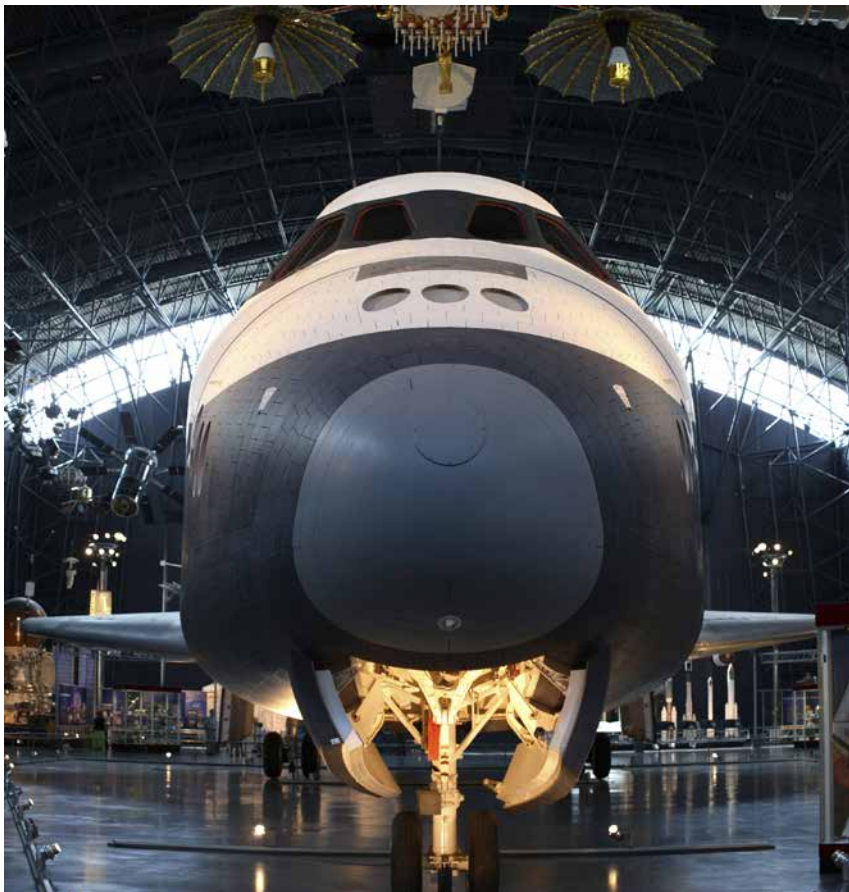
미국의 우주왕복선 엔터프라이즈. 대기권 재돌입시의 열에 견디기 위해 표면을 촘촘하게 세라믹스 소재로 덮었다. 세라믹스는 가혹한 환경을 버텨야 할 때 종종 이용된다.
