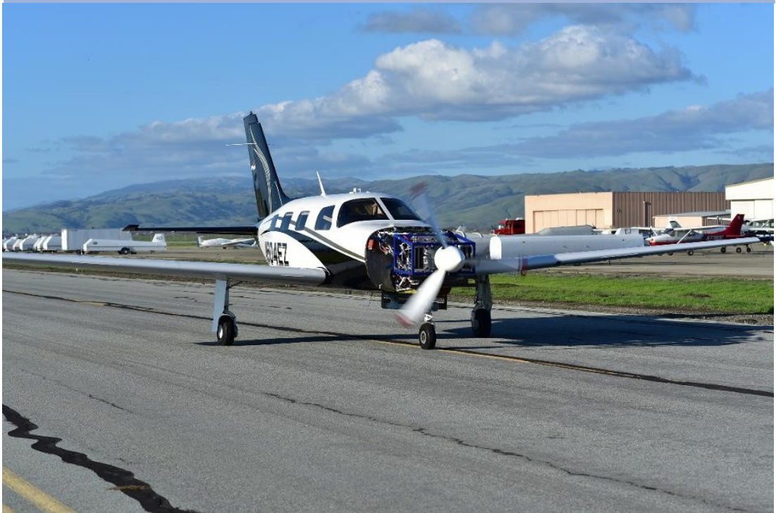
그림 10. 300마일(480km)을 목표로 ZeroAvia는 Piper Matrix를 기반으로 개조한 수소 비행기를 시험 중이다. 운항 거리 목표는 500마일(800km)이다.
