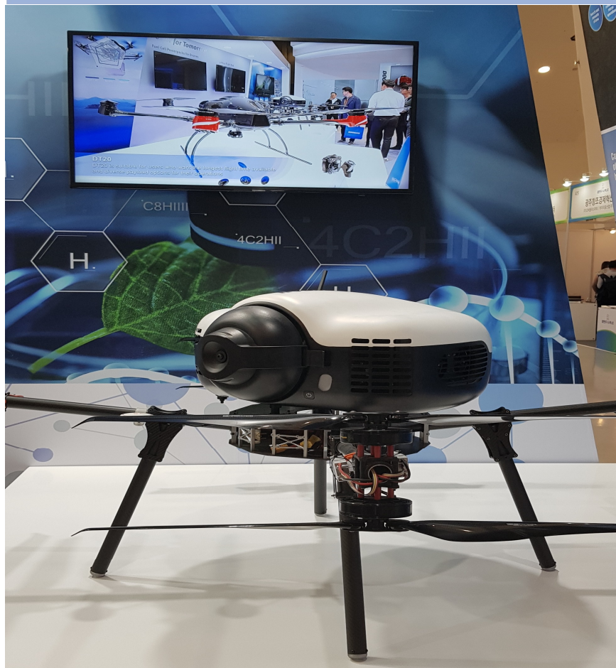
그림 8. 두산 모빌리티 이노베이션에서 개발 중인 수소연료전지를 이용한 드론
