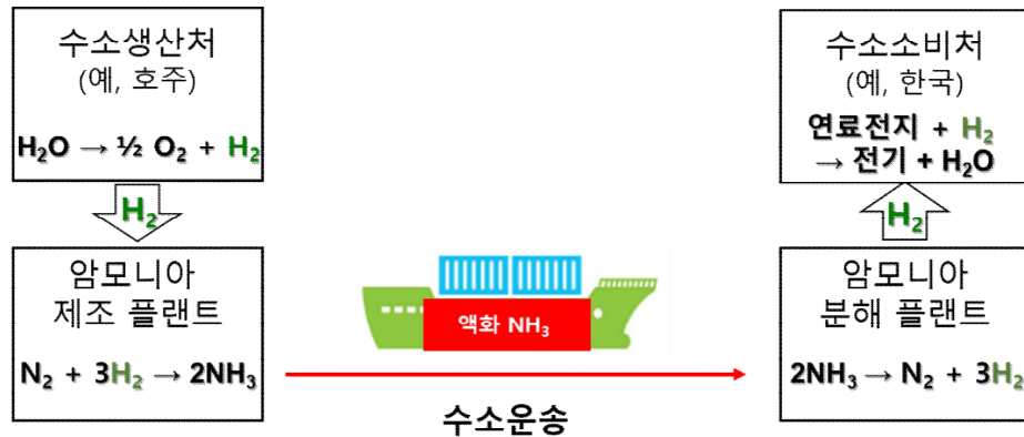
그림 18 암모니아 기반 수소저장·운송 개념
