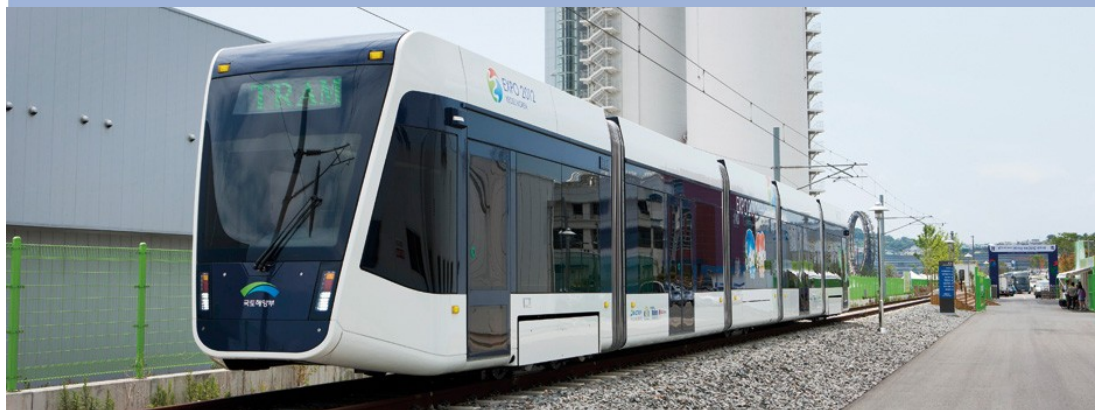
그림 7. 현대로템에서 개발한 무가선 저상 트램은 배터리 트램으로 70km/h의 설계 최고 속도를 가지고 있다. 이를 기반으로 수소 전기 트램의 개발도 진행 중이며, 수소 1회 충전으로 200km 이상의 주행 목표를 가지고 있다.
