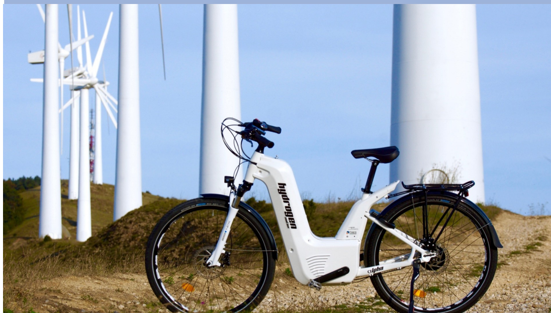
그림 11. 프랑스 기업이 프라그마(Pragma)가 개발한 수소전기자전거 Alpha 2.0. 전기자전거보다 주행 거리가 더 길다는 것을 실증하였다
