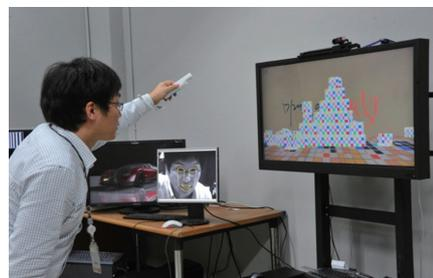
▲ KIST 관찰자 추적 방식의 인터랙티브 다시점 3D 표시 시스템
