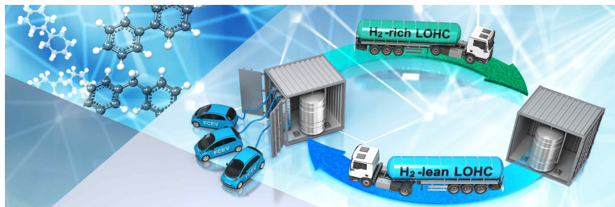
그림. 액상유기수소운반체(LOHC)가 수소 운반체로 이용되는 모식도
